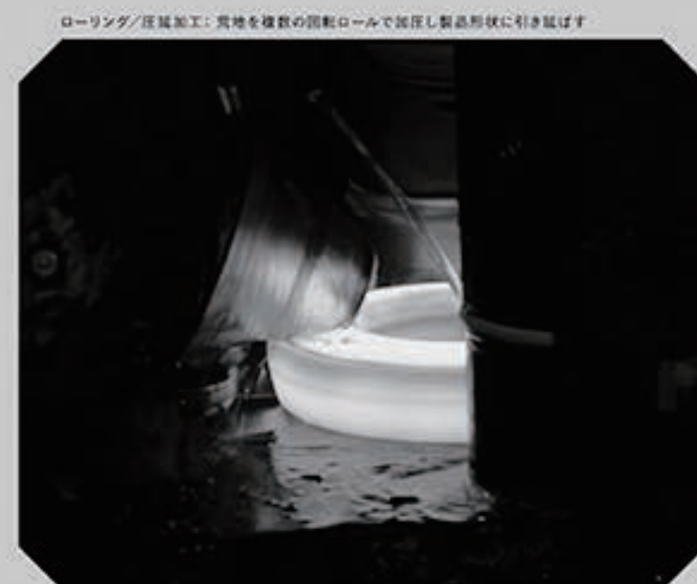
ローリング/圧延加工：荒地を複数の回転ロールで加圧し製品形状に引き延ばす
