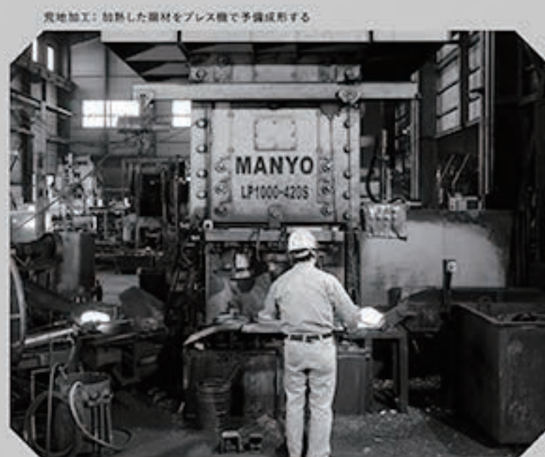
荒地加工：加熱した鋼材をプレス機で予備成形する
