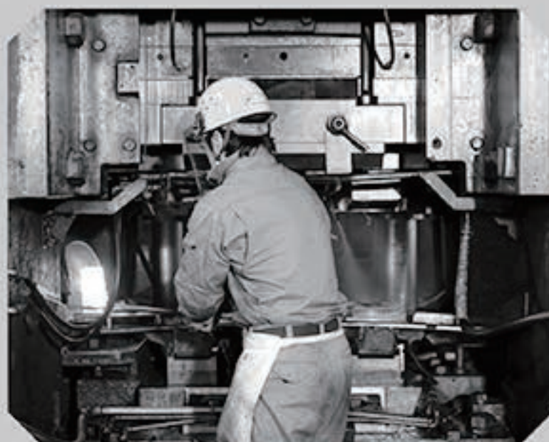
型打ち加工(4000Tプレス)：加熱した鋼材を複数の上下型で加圧し成形する
