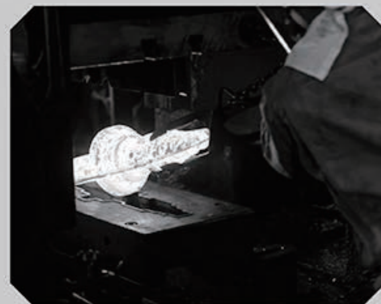
トリミング：バリ(余分な部分)を取り除き製品形状に仕上げる
