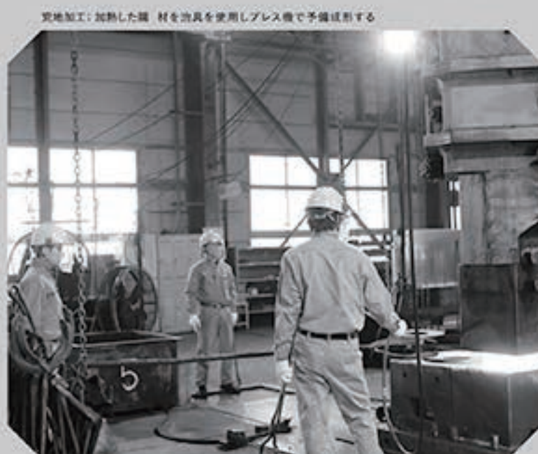
荒地加工：加熱した鋼材を治具を使用しプレス機で予備成形する
