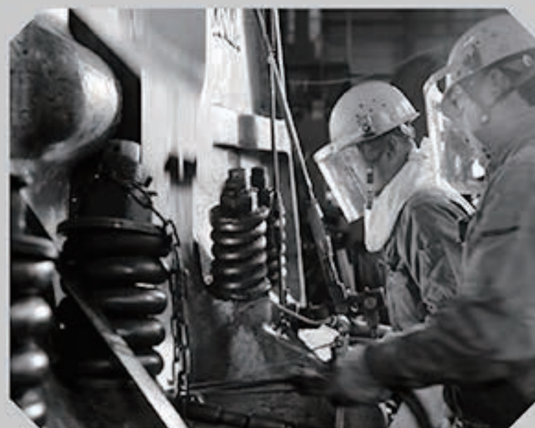
型打ち加工(4Tハンマー)：加熱した鋼材を上下型で高速打撃し成形する
