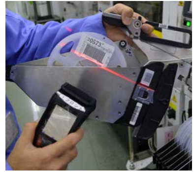
▲バーコード利用による実装部品段取り
