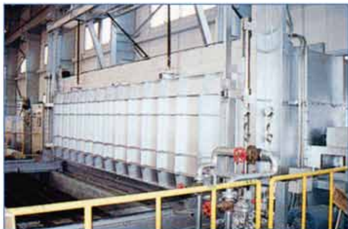
▲ 焼入炉・溶体化処理電気炉
