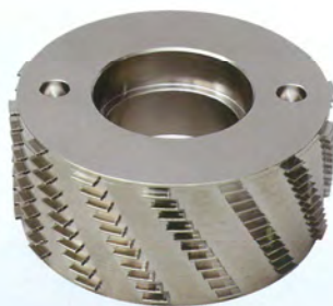
▲ カッター 同時5軸マシニングによる加工
