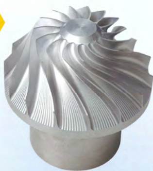
▲ インペラ 同時5軸のマシニングによる加工
