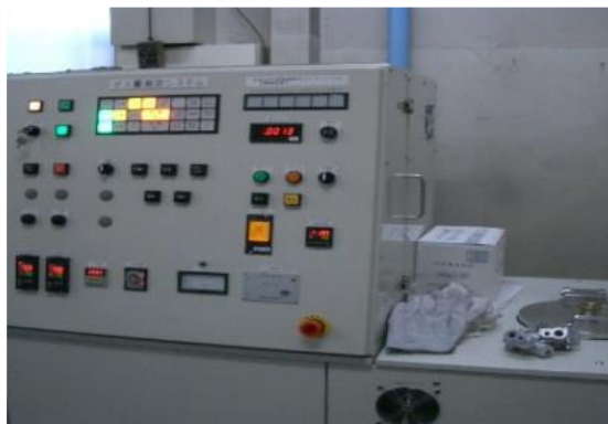
ガス量測定装置
