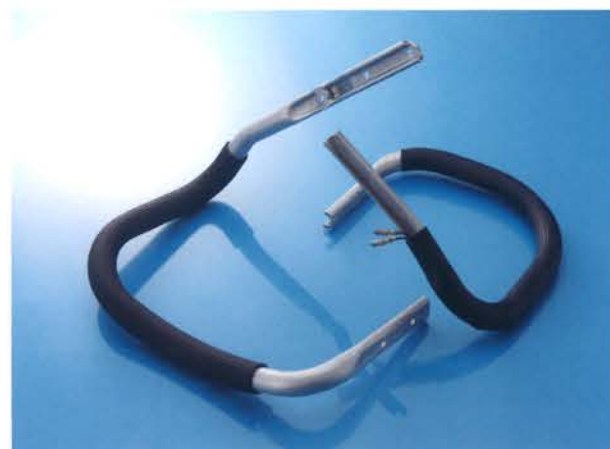
曲げ+プレス(潰し・穴開け)+ヒーター取付+グリップ挿入
