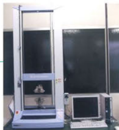
万能試験機…材料試験片の強度を測定する。
