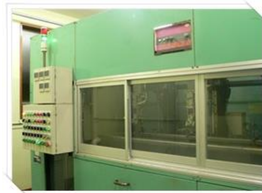
4槽式自動洗浄機
