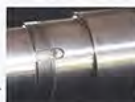
②軸部の仕上げ作業
