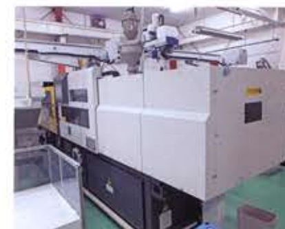
射出成型機……軟膏容器等の成型に使用
