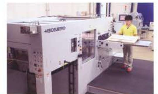
世界第1号機 ハイデルベルグ社製 バリエマトリックス(平盤打ち抜き機)
