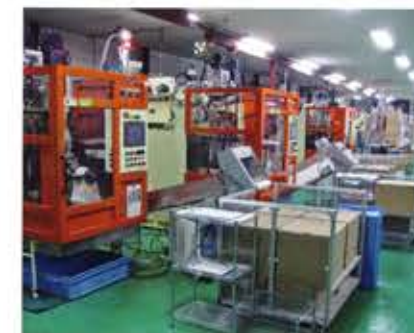
射出成型機……軟膏容器等の成型に使用
