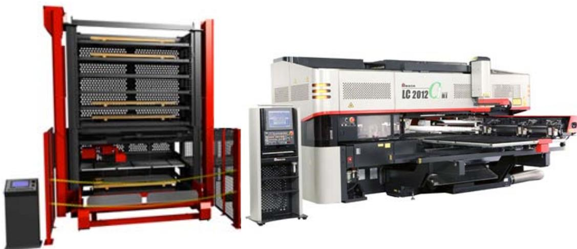
抜き加工 (NC レーザー複合機)
