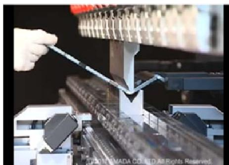
曲げ加工 (圧力 130t 長さ 3m)
