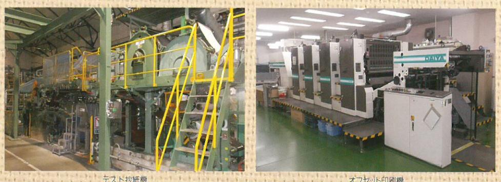
抄紙機・コーティングなどのテストプラント、市場と同水準の製版・印刷機を運用し、製品試作や品質評価、更には当社製品の特長をわかり易くお伝えするための製品見本の作製、新規用途開発などを行っております。
