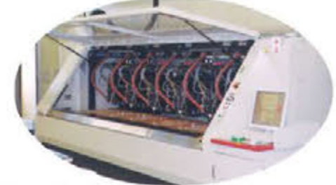
Σ621 6軸(高精度座ぐり機能付き)ルーター加工機
